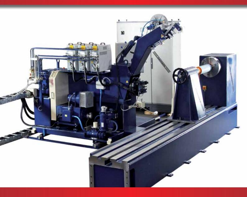
IMPIANTO ESTRUSORE PER RIVESTIMENTO CILINDRI
